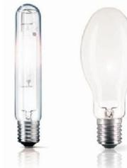
✓ **Mista**: Possuem, ao mesmo tempo, características das lâmpadas incandescentes, fluorescentes e de vapor de mercúrio. O bulbo ovóide é revestido internamente com material fluorescente e contém um tubo de descarga a vapor de mercúrio que emite radiação visível e radiação ultravioleta invisível, que é convertida em luz visível através do revestimento interno.
